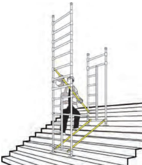
**6** Placer une diagonale entre le 7ème barreau du cadre-porte bas et le 7ème barreau du cadre-porte haut. Positionnez un cadre 7 barreaux sur le cote haut de la tour, en vous positionnant sur une marche plus élevée que la base du cadre.
